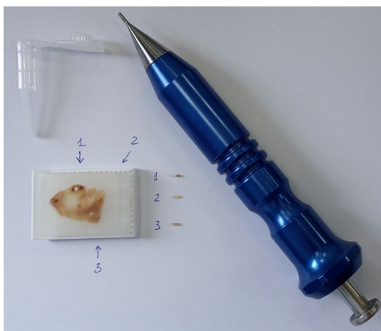
Рис. 10. Исходный блок-донор, пробирка для иссечённого материала, перфоратор для создания тканевых матриц с иглой диаметром 0,6 мм, образцы тканей, диаметром 0,6 мм из разных участков опухоли.
