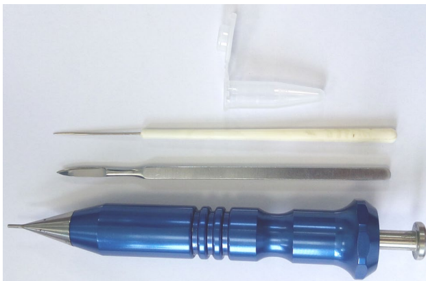
Рис. 9. Инструменты, необходимые для выполнения ручной микродиссекции: пробирка, препаровальная игла, скальпель, перфоратор для тканевых матриц.
